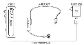
可连接移动电源、 电脑USB或电源适配器进行充电;
