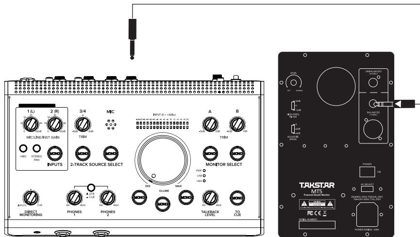
连接MT5有源监听音箱非常简单，让我们快速查看以下典型的安装连接例子，首先把需要的各种音源信号接入到调音台的输入接口，从调音台主L/R输出连接到MT5有源监听音箱的任意一组输入接口，至此系统连接完毕，您可畅快播放音乐，沉浸其中...感受MT5如何淋漓尽致地展现各种音乐，各种乐器；
