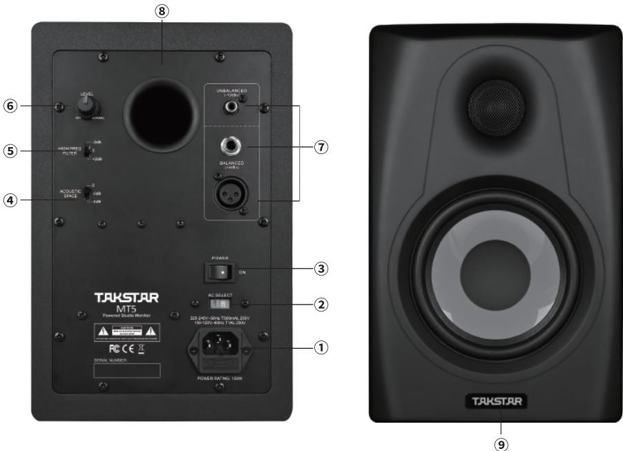
①电源连接和保险丝：将电源线牢固地连接到IEC插座上，并将另一端插入交流电源插座；确保交流电源插座的电压与监听音箱上选择的交流电压一致；
