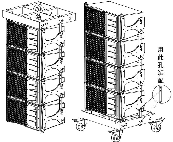
(吊/挂装方式承重1000斤≤)      (另:加4个轮子方便移动)
