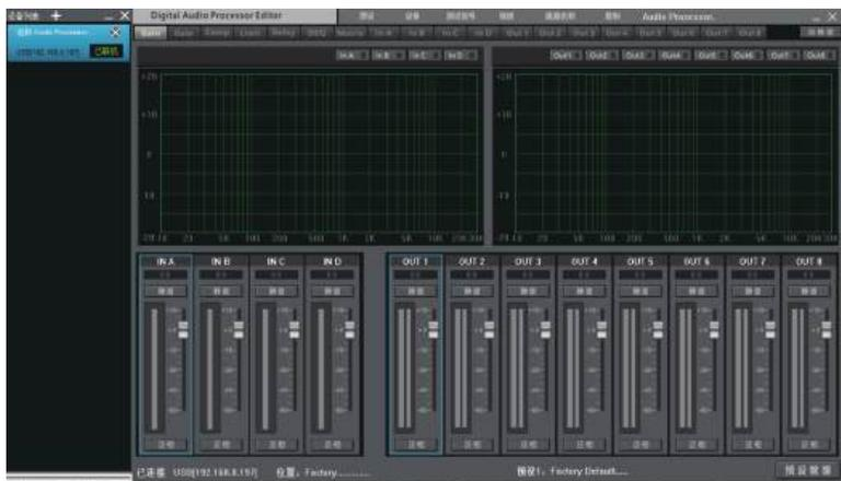
PC软件可以通过网络对单台或多台在线设备进行配置和管理，可将设备参数存储在设备或电脑文件中。多达250台设备可以同时联机在线，方便实时切换编辑。灵活的参数编辑，编组联调为用户的快速设置提供了极大的便利。
