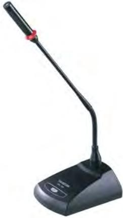
*MS-188* 台式会议麦克风，采用背极式驻极体电容音头，具有灵敏度高、噪音低、性能稳定、环境适应能力强等特点，音质清晰自然，超心型指向拾音方式。头部带有红色光环状态指示。底座上设有静音开关，操作方便、简单、实用，广泛应用于会议演讲、会议系统安装、公共传播等场合。
