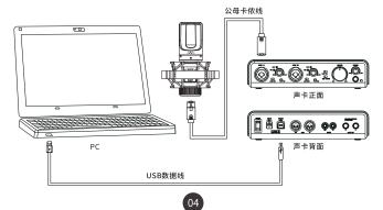
② 音频设备不带48V幻象电源供电的连接方法:
