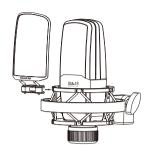
4. 将麦克风的接口通过公母卡侬线连接到具有48V幻象电源的音频设备(如声卡 、调音台、功放等),如果设备本身没有幻象电源,则需要另购一个48V幻象 电源进行连接;
