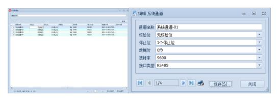
系统通道接口设置选择项如下表所示,为保证串口的通讯成功,请保证 WM-PL 系列可编程中控主机主机串口和设备相联的串口参数设置完全相同。
