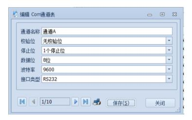
通道接口设置选择项如下表所示,为保证串口的通讯成功,请保证 WM-PL 系列可编程中控主机主机串口和设备相联的串口参数设置的匹配。
