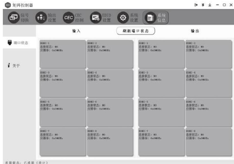
**端口状态:**在操作界面显示输入端(HDMI1~HDMI8)的连接状态及当前分辨率显示,输出端(HDMI1~HDMI8)的连接状态及当前分辨率显示。
