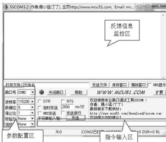
在参数配置区正确填写串口线与PC机连接的串口号, 通讯协议的波特率、数据位、停止位、校验位, 即可在命令输入区输入指令, 对本机或远端接收器进行控制。
