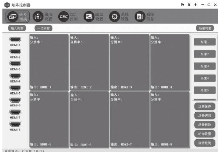
1. 菜单栏:主要包括“信号切换”、“输出设置”、“CEC控制”、“EDID设置”、“系统设置”、“系统信息”等5个操作界面。
