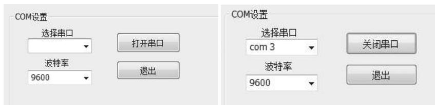
串口连接: 电脑通过串口连接电源控制器, 然后选择COM通道, 如COM1, 最后打开串口, 成功后按键状态变为关闭串口。使用完后点退出软件。
